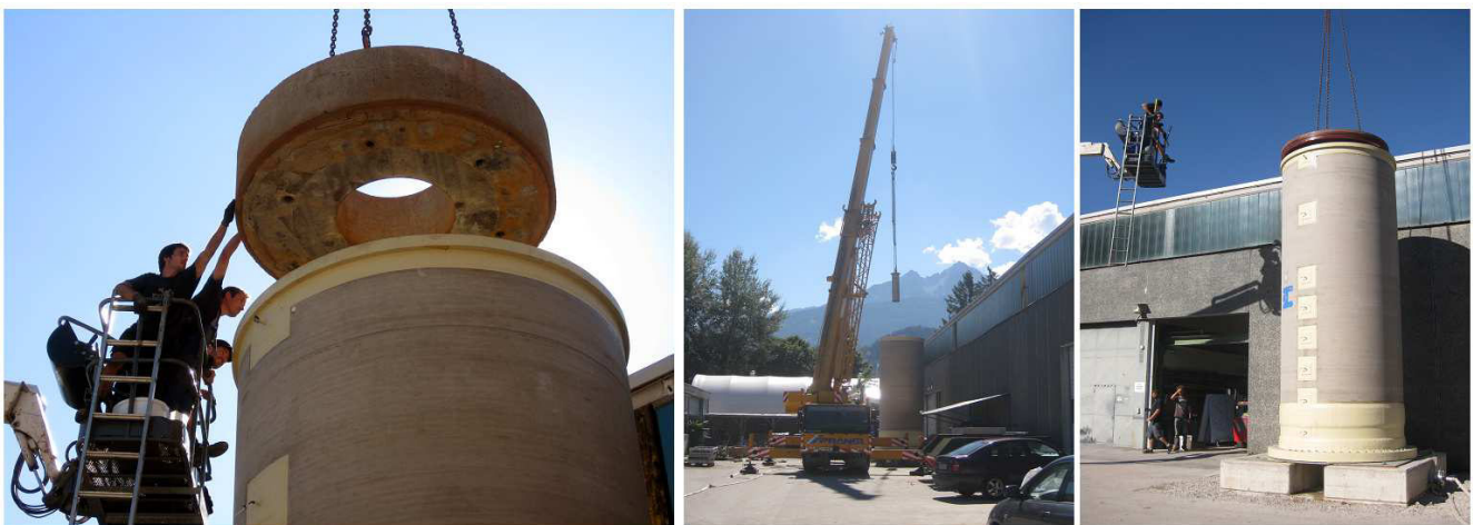
Abb. 10: Aufbau Modellversuch PT2 mit innenliegender Pump turbine
