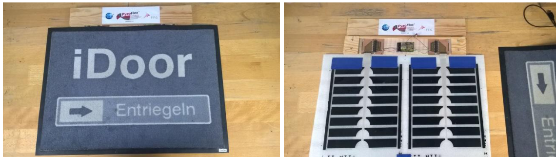
Abbildung 10: Weiterentwickelter ECO-Teppich einschließlich Wireless-Ausleseseinheit
