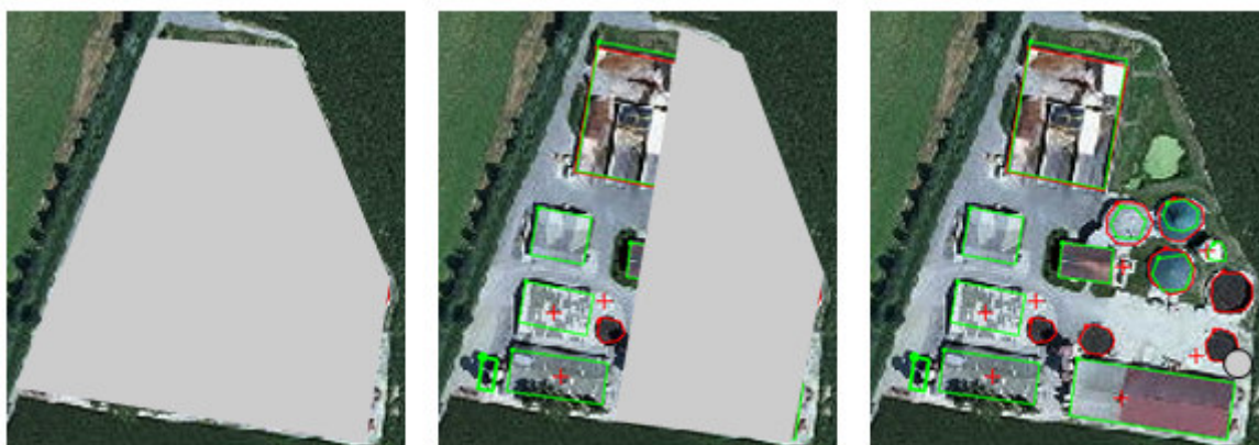
Abbildung 15: Schematische Darstellung von Quelldimensionen am Standort der Referenzbiogasanlage zur Sensitivitätsanalyse (links: homogene Quelle als Fläche oder Volumen am gesamten Standort; Mitte: homogene Quelle als Fläche oder Volumen auf der Hälfte des Standortes, rechts: Punktquelle [grauer Kreis])
