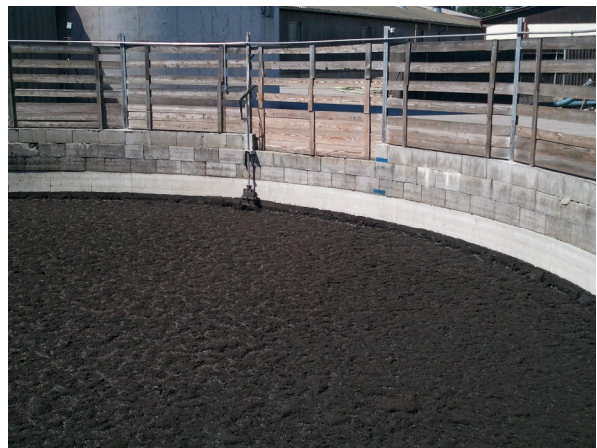
Abbildung 14: Temperatur Datenlogger LOG32 (links) für kontinuierliche Temperaturmessungen in einem Gärrestlager. Rechts: Die Referenzgrube ( V = 600\text{m}^3 ) mit einer Messskala (blaue Markierungen)
