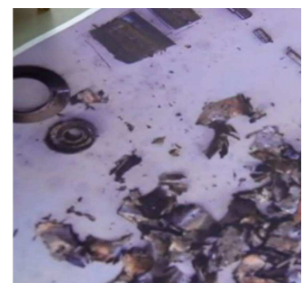
Bild 8: Reste nach dem Bruch eines Innenläufer-Rotor aus laminierten Eisenblech (Dynastore)
