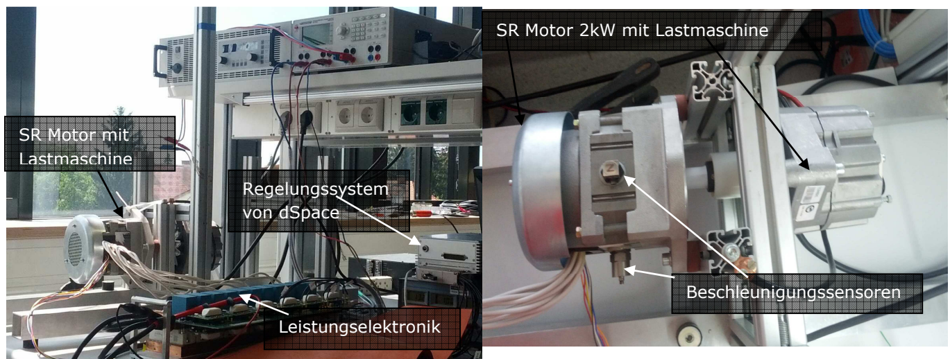
Bild 15: Laboraufbau zur Untersuchung der Geräuschreduktion
