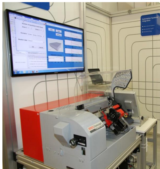
Abbildung 16: Messe-Exponat mit eingebundener Werkzeugmaschine, Leistungsmessgerät (im Hintergrund) und grafischer Benutzeroberfläche der Gesamtsimulation.
