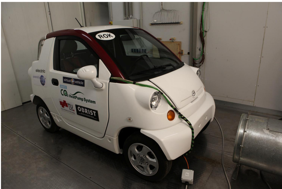
Abbildung 74: Fahrzeug mit Messtechnik in der Klimakammer
