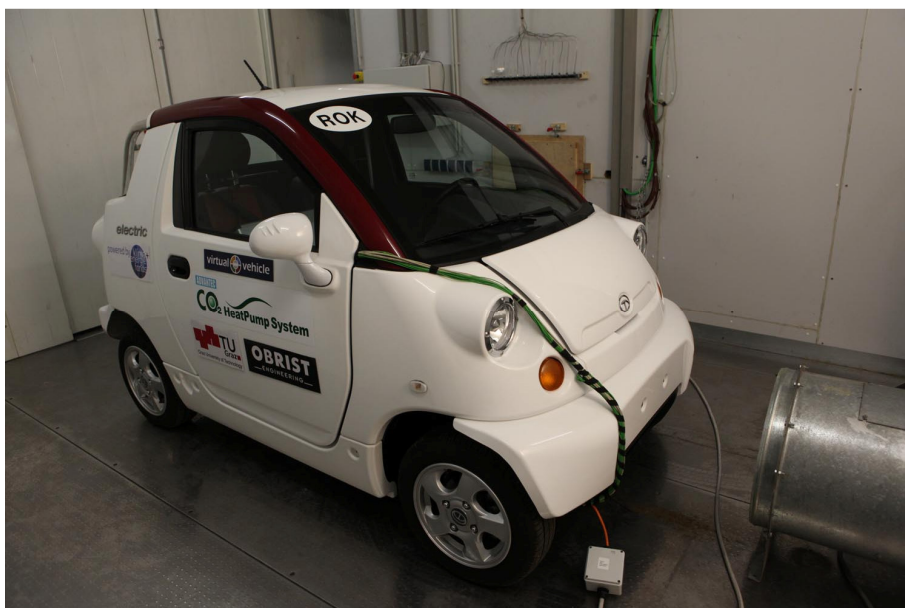
Abbildung 45: Fahrzeug mit Messtechnik in der Klimakammer
