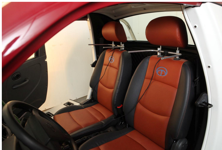
Abbildung 46: 4 Temperatursensoren im Kopfbereich der Passagiere
