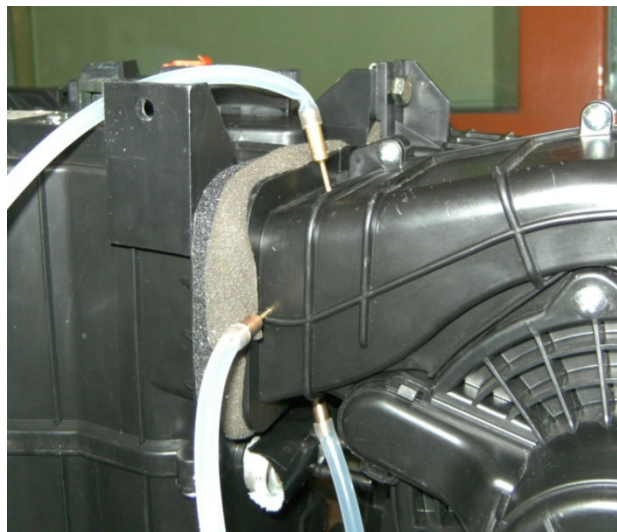
Abbildung 15: Anbringung der Druckmessstellen an der HVAC-Box
