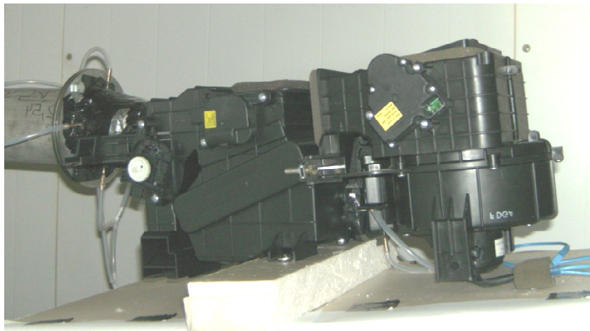
Abbildung 13: HVAC-Box verbunden mit dem Mess-Rohr
