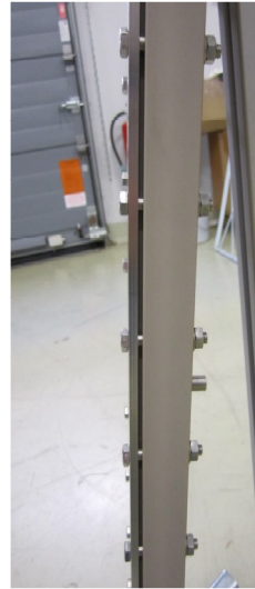
Abbildung 2: Wärmeübertragerplatte und Flüssigkeitsverteiler (links) und Seitenansicht mit angeschraubter Sekundärseite (rechts)
