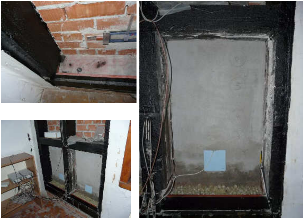
Abb. (189) links oben: Innenansicht mit Blick in das Gefäß zum Einfüllen des Wassers vor Anbringung der Messtechnik und des Innenputzes, links unten: Aufnahmen während der Messungen am 8. Oktober 2012, rechts: frontale Innenansicht des beheizten Feldes A
