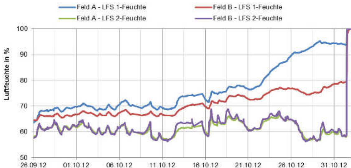
Abb. (193) zeitlicher Verlauf von relativer Luftfeuchte (unten) zwischen Putzschicht und Mauerwerk in beiden Testfeldern vom 26.9.2012 bis zum 1.11.2012
