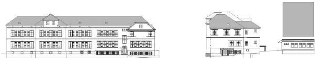
Abb. (311) Solarnutzungsflächen am Referenzgebäude „Schulgebäude“ linkes Bild: Ausprägung „groß“ auf der Dachfläche dargestellt als Südansicht rechtes Bild: Ausprägung „klein“ auf den Dachflächen des Nebengebäudes, dargestellt als Südansicht
