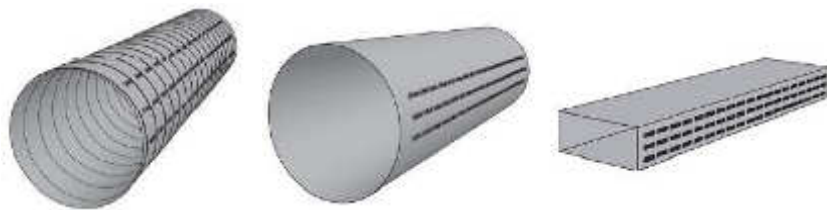
Abb. (356) Wickelfalzrohr, Glattrohr, eckige Ausführung (von links) (Pichler, 2010, S. 4)
