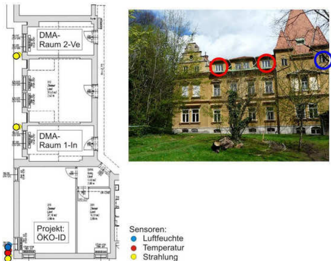
Abb. (37) links: Grundriss Dachgeschoss mit Außenklimasensoren und Räumen; rechts: Außenansicht Südwestfassade Schönbrunnngasse 30 mit verbessertem Kastenfenster (linker roter Kreis), instand gesetztem Kastenfenster (rechter roter Kreis) sowie Außenklimamessung (blauer Kreis). Das gesamte Dachgeschoss wird lediglich als Abstellraum benutzt. In Abb. (116) sind die externen Sensoren markiert.
