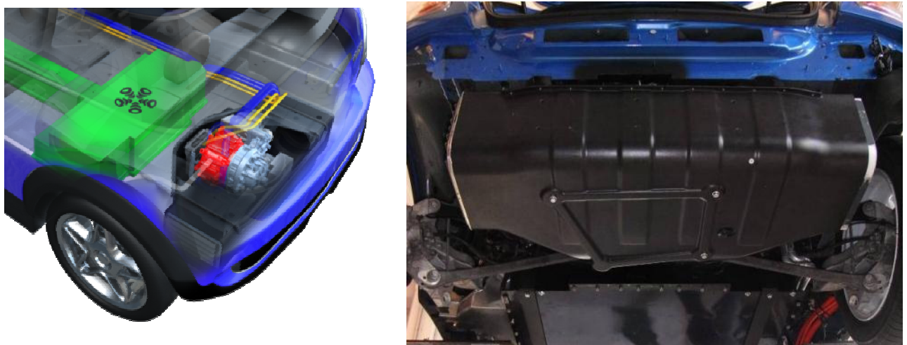
Abb. 11: Range Extender Einheit in CAD und Einbauzustand (Untersicht ohne Heckschürze)
