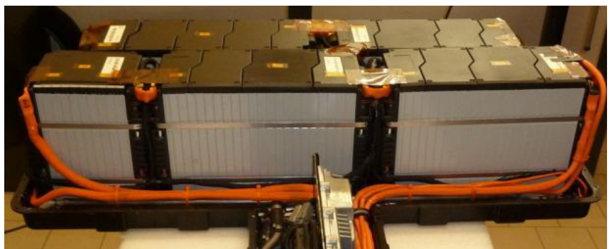
Abb. 9: Batterieaufbau mit Trägerstruktur
