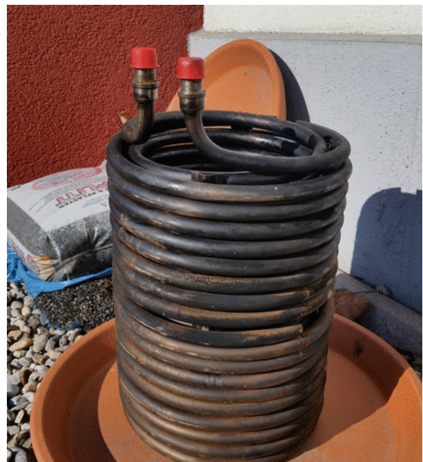
Abbildung 44: Heizspule aus korrodierbarem Material, in der die Partikelfreisetzung stattfindet.
