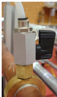
Abbildung 28: Anschlussstück mit Messingring, Mini-Kugelhahn und flexibler transparenter Leitung (links), Messsonde mit 1 mm Ringbohrung (rechts)
