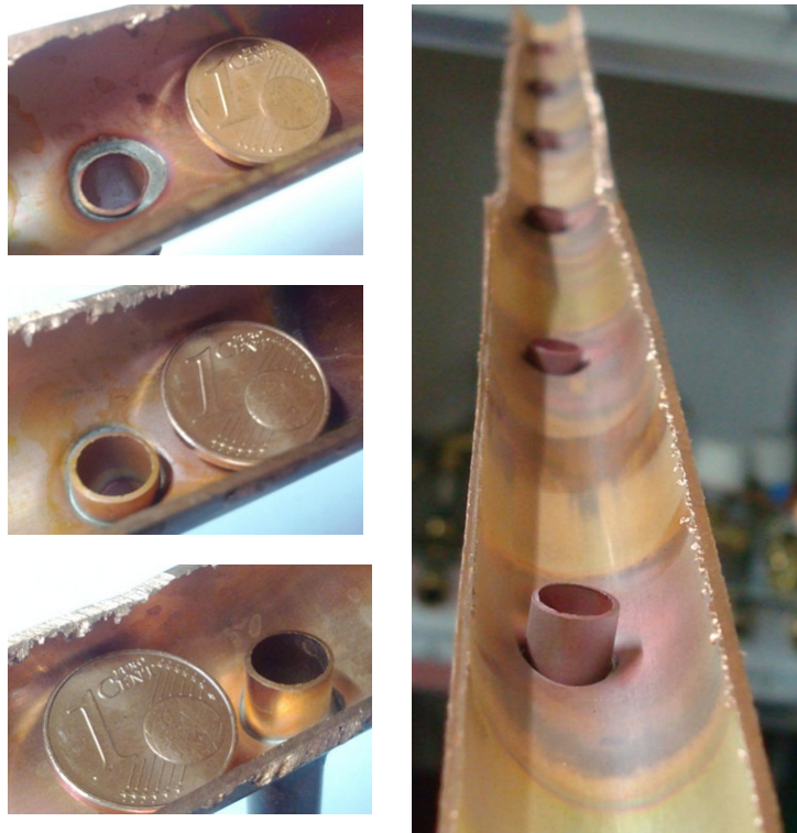
Abbildung 14: Beispiele von Absorberrohren, die unterschiedlich weit in das aufgeschnittene Sammlerrohr hineinragen und aufgeschnittenes Sammlerrohr mit hineinragenden Absorberrohren eines marktüblichen Rohrregisters.
