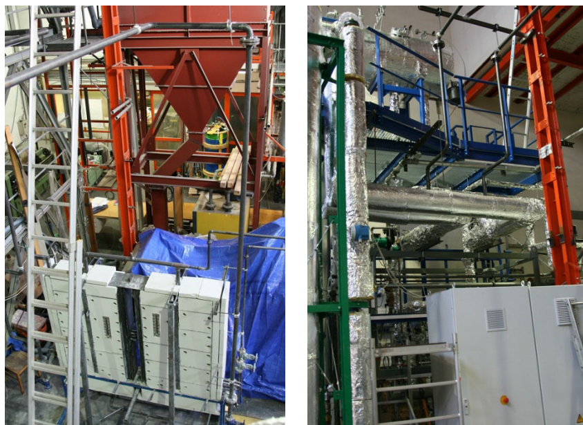
Abb. 3.7: Umsetzung des Zwei-Kammer-Regenerators im Labor der TU-Wien
