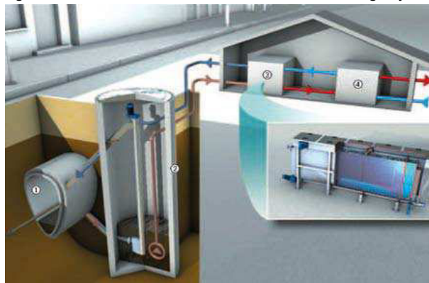
Abb.4: System zur Wärmeabgewinnung von Kanalabwasser außerhalb der Kanalleitung; Systemdarstellung Huber ThermWin
