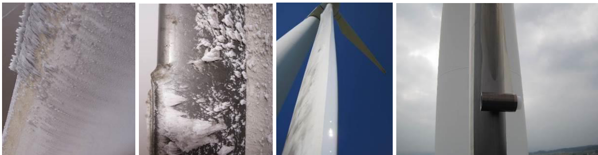
Abbildung 9: Modifizierung der Oberflächen für Wintertest mit coating (ganz links) und Folie (2. von links) und Eisaufbau an diesen modifizierten Oberflächen im Wintertest
