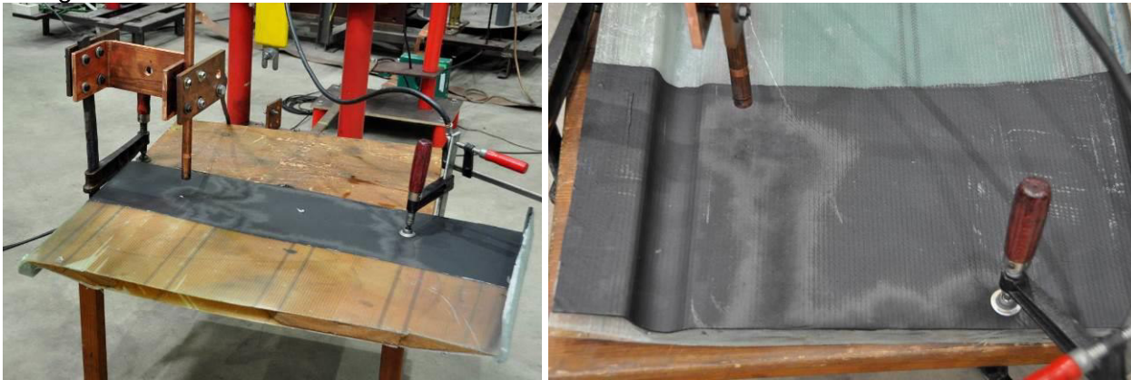
Abbildung 18: Aufnahmen des Aufbaus (links) und Markierungen (Schmauchspuren) nach Blitztests bei AIT
