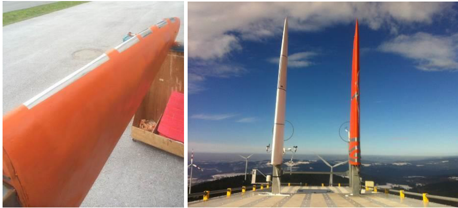
Abbildung 21: links: mit Heizsystem ausgestattete und später fix an der Gondel montierte (Signalrot lackierte) Flügelspitze; rechts: Ausführung der Blattspitze mit Edelstahl-Erosionskanten
