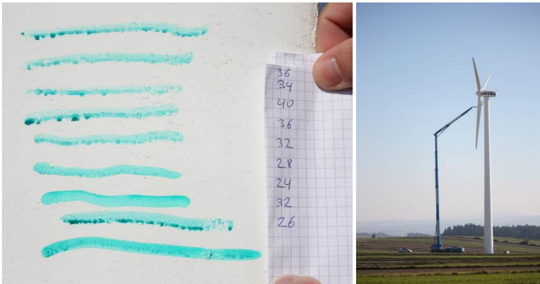
Abbildung 15: Bestimmung der Oberflächenspannung mittels Testtinten; rechts: Hubsteiger an der WEA in Oberstrahlbach
