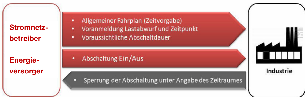
Abbildung 3.6: Kommunikation der Lastverschiebung in der Industrie
