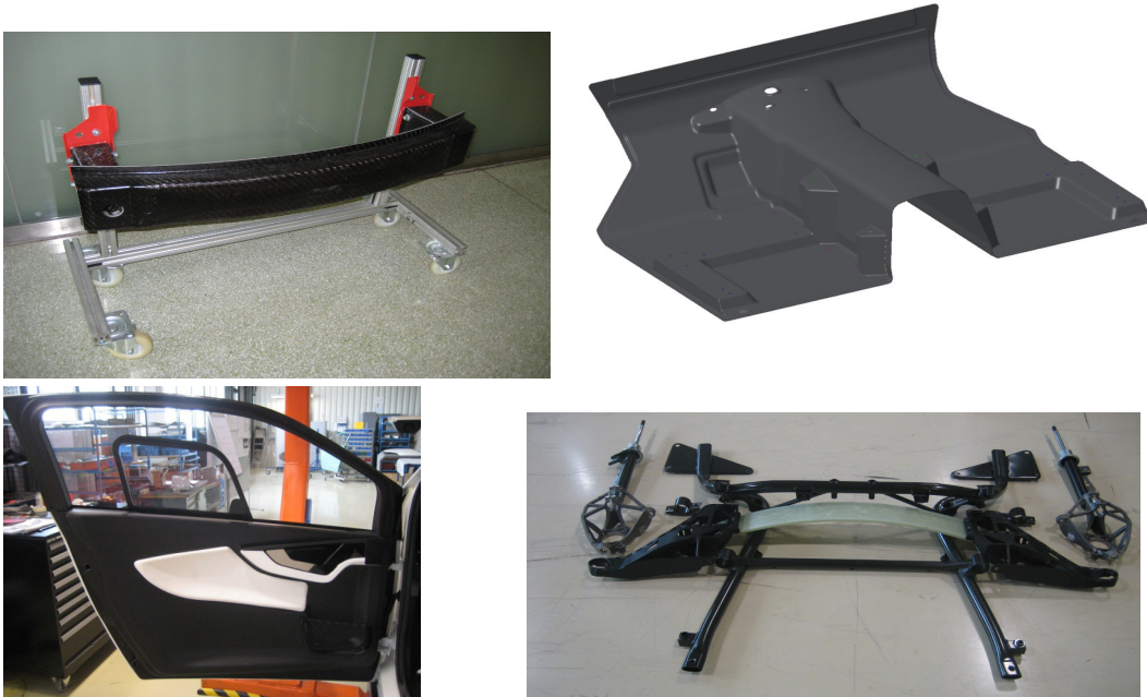
Abbildung 2-4: Funktionsintegrierte Leichtbautechnologien CULT (v.li. o. n. re. u.: CFK-Sandwich-Bodengruppe, Organoblech-Querträger und Crashboxen, Sandwich-Schaum-Fahrtür mit Kunststoff-Schiebefenster, Leichtbau-Achssystem mit GFK-Querblattfeder)
