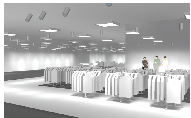
Abbildung 6: Alternative Beleuchtungslösung – Reduktion der Leuchtdichte auf der Verkehrsfläche führt zu verbesserter Akzentuierung der Ware
