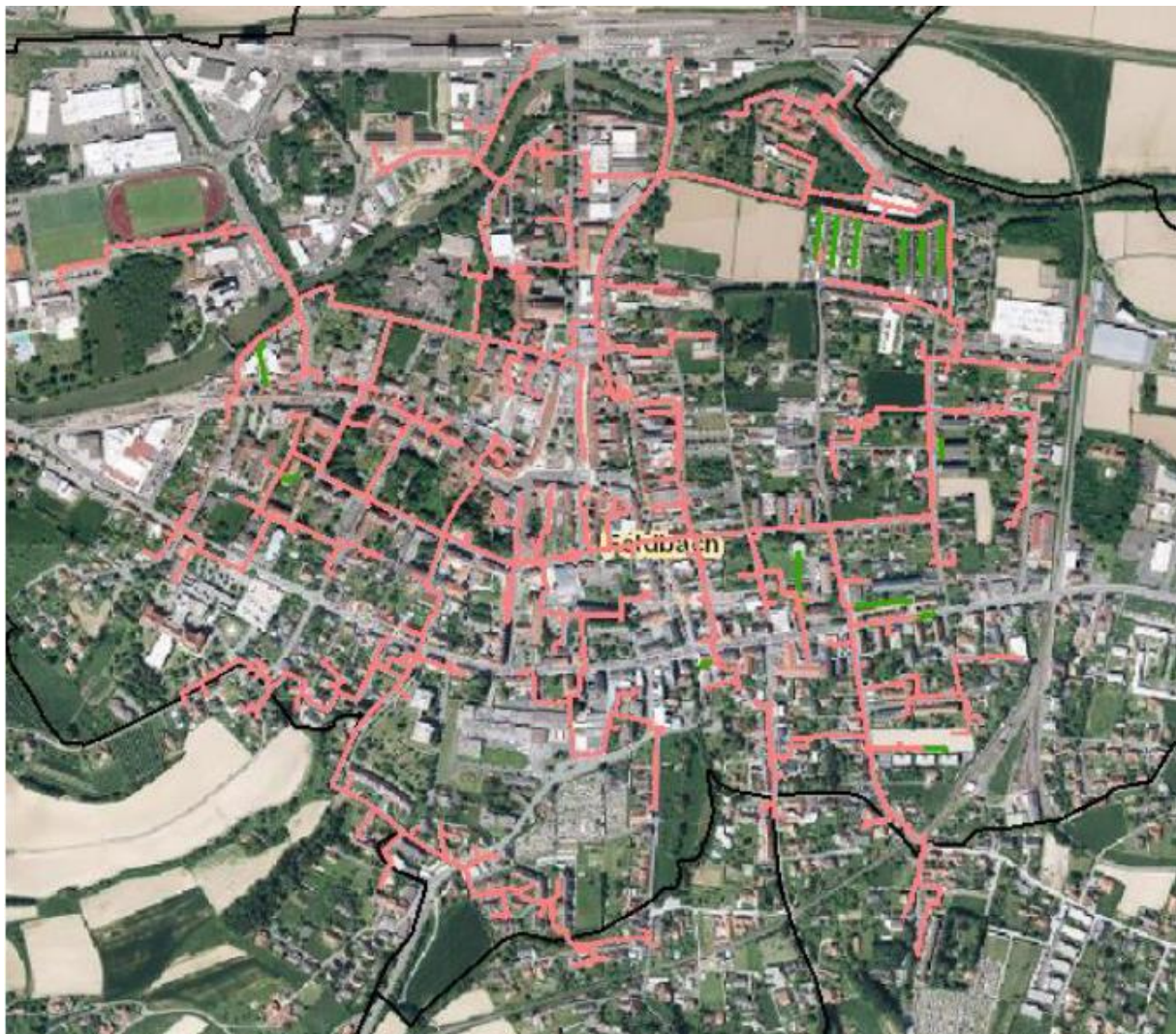
Abbildung 1: Überblick Fernwärmenetz Feldbach
