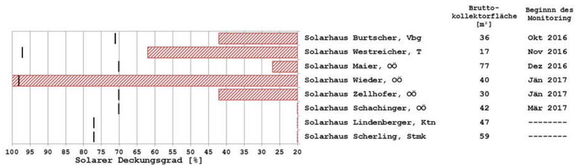
Abbildung 3: Vergleich der gemessenen solaren Deckungsgrade (rote Balken) mit den prognostizierten solaren Deckungsgraden (schwarze Striche) der 8 Solarhäuser (Monitoringzeitraum bis einschließlich Februar 2017)
