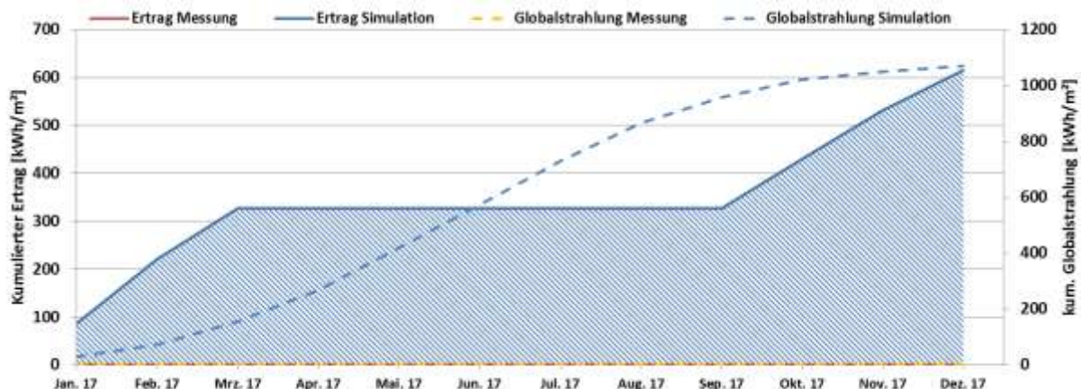
Abbildung 9: Prognostizierter Verlauf des spezifischen Solarertrags und der Globalstrahlung in Kollektorebene für die Anlage „Audio Tuning Vertriebs GmbH“
