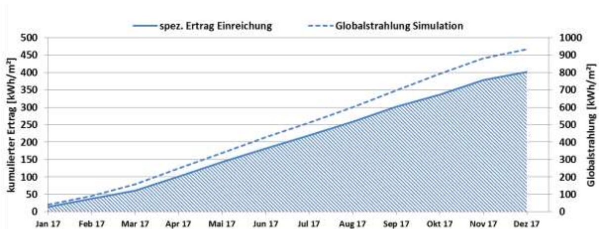
Abbildung 32: Prognostizierter Verlauf des spezifischen Solarertrags (bezogen auf die Aperturfläche) und der Einstrahlung in Kollektorebene für die Anlage „Gärtnerei Bach“
