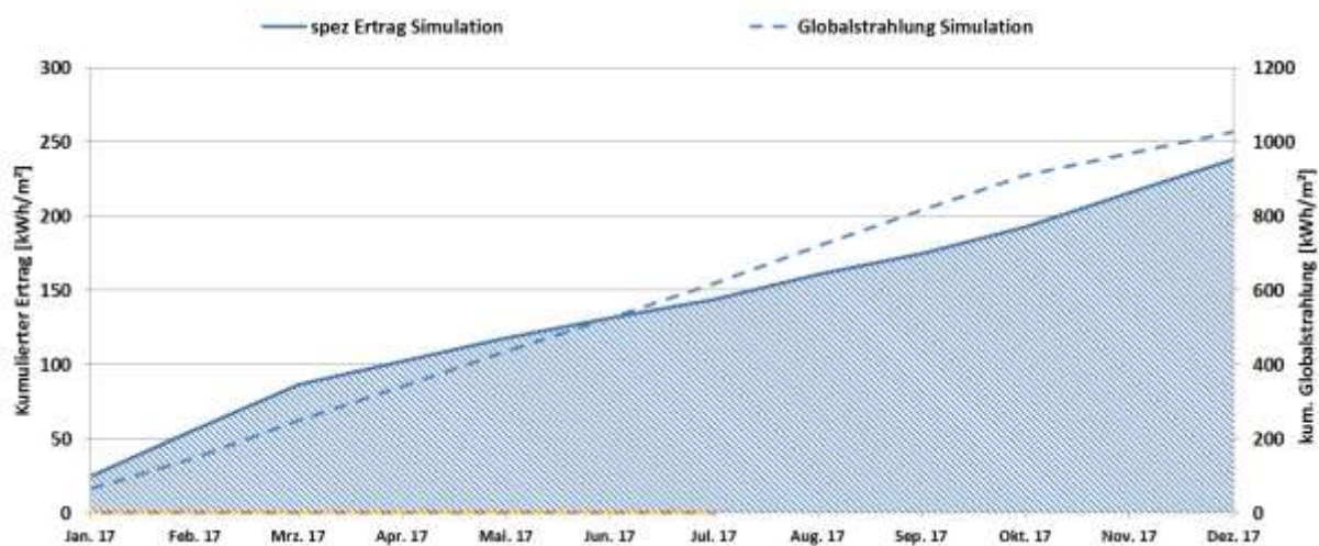
Abbildung 30: Prognostizierter Verlauf des spezifischen Solarertrags (bezogen auf die Aperturfläche) und der Einstrahlung in Kollektorebene für das Solarhaus Edl
