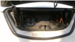
Links Buchse: CHAdMO - Gleichstrom Schnellladung (bis zu 40kW), Ladung bis ca. 80 % Ladestand der Batterie in ca. 30 min
