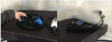
In der Abbildung links dargestellt das „Ladekabel Typ1 - Typ2“ für den Typ1 Stecker am Auto für eine Typ2 Buchse an der Wallbox/öffentlichen Ladestation.
